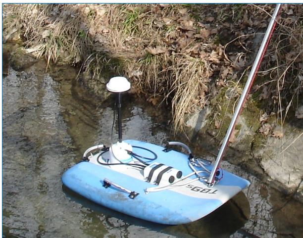
Abb. 2: Das Foto zeigt ein kleines Messboot, vergleichbar einem Surfbrett, das mit einem Sensor und einer GPS-Antenne ausgerüstet ist.
