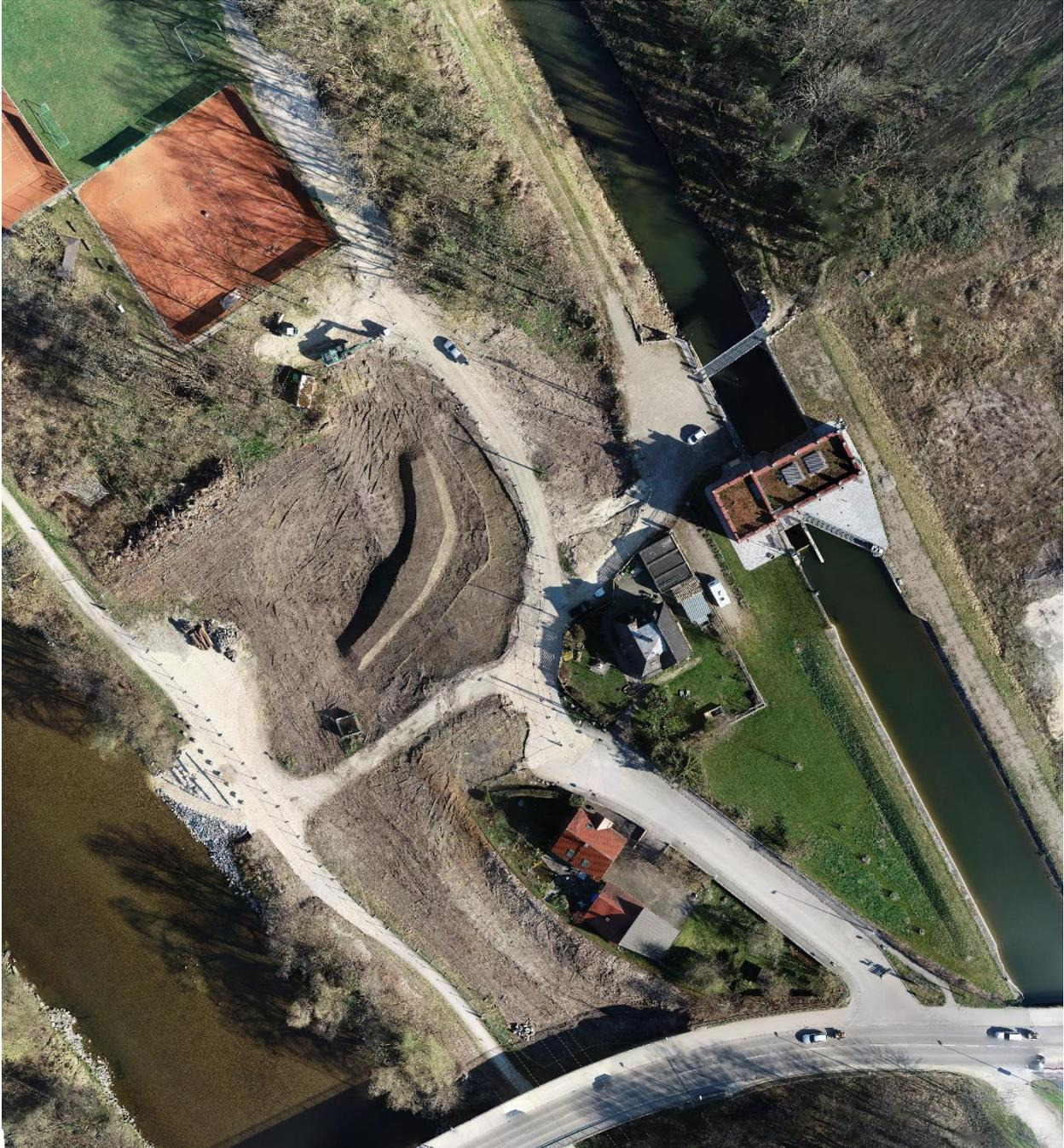
Abbildung 30: Bauabschnitt 5 mit Deichsanierung für den Hochwasserschutz der Stadt Senden
