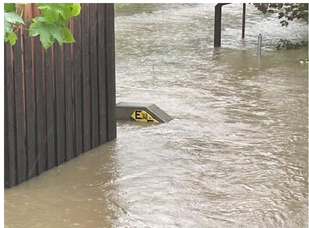
Abbildung 35: Der Pegel in Aichach am blauen Steg – Die Pegellatte ist fast überstaut
