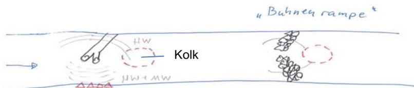
**Abbildung 4 Gestaltung von Leitwerken entgegen der Strömungsrichtung**
