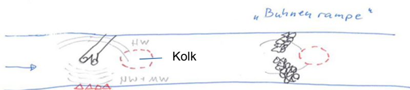
Abbildung 4 Gestaltung von Leitwerken entgegen der Strömungsrichtung
