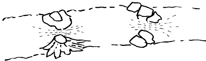
Abb. 1: Schlitzrampen mit Strömungsbündelung
