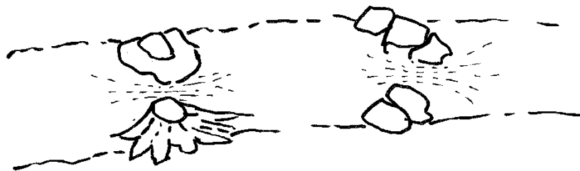
Abb. 1: Schlitzrampen mit Strömungsbündelung
