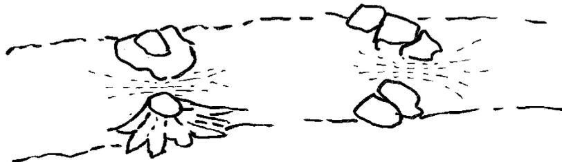
Abb. 1: Schlitzrampen mit Strömungsbündelung
