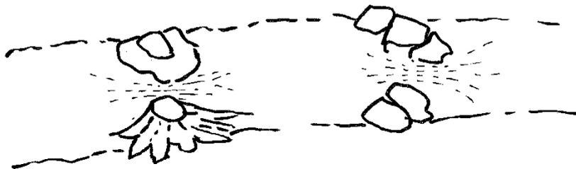
Abb. 1: Schlitzrampen mit Strömungsbündelung
