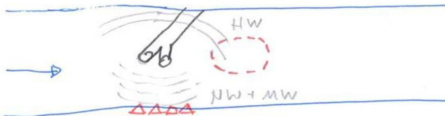
Abb. 4: Wirkung von Leitwerken entgegen der Strömungsrichtung
