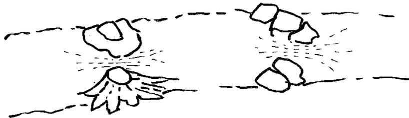
Abb. 1: Schlitzrampen mit Strömungsbündelung
