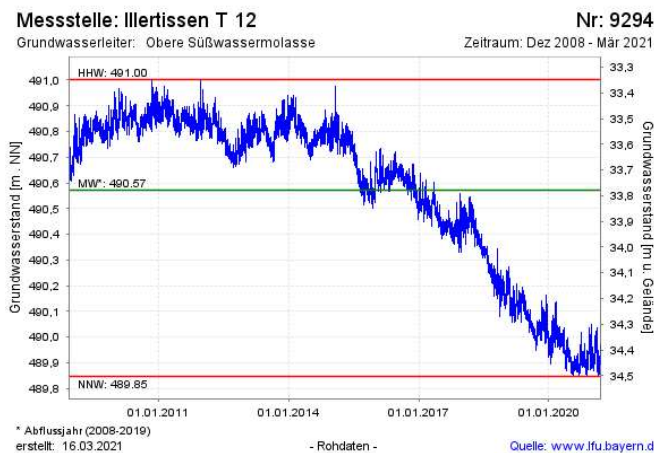
Abb. 4: Grundwasserstände der Messstelle Illertissen von Dezember 2008 bis März 2021. Seit 2014 ist aufgrund der geringen Auffüllung der Speicher ein sinkender Trend erkennbar. Quelle: Bayerisches Landesamt für Umwelt
