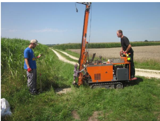
Ausführung einer Rammkernsondierung
