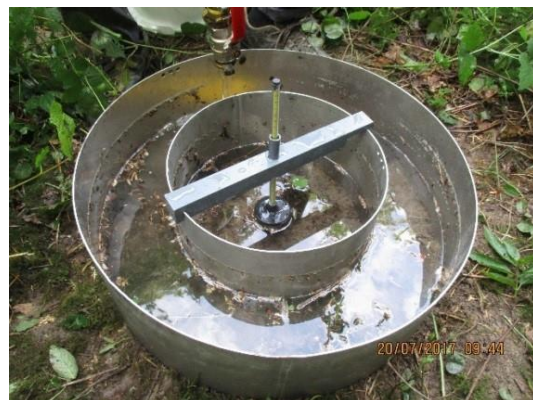
Bestimmung der Wasserdurchlässigkeit im Gelände (Doppelringinfiltrrometer)
