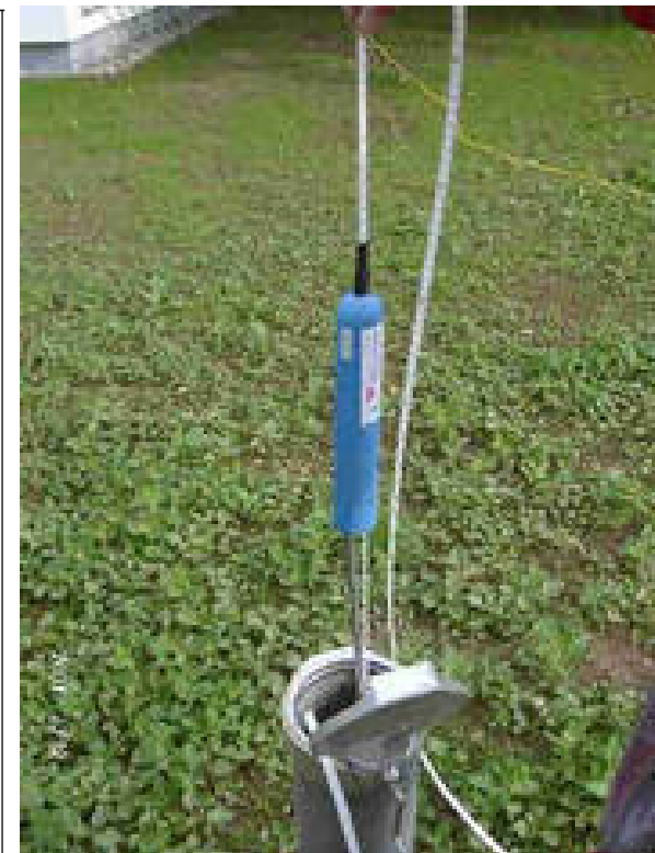
Grundwassermessstelle mit Datenlogger Quelle Foto: www.illarentwicklung.de
