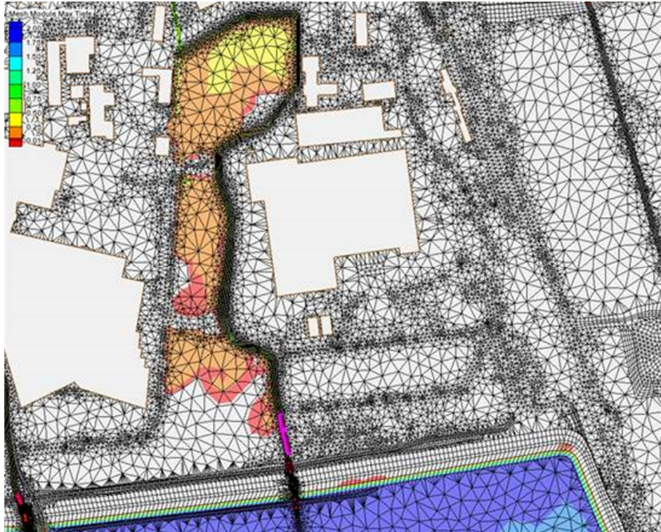
Abb. 12: Lage mögliche Ufererhöhung als pinkfarbene Linie am östlichen Ufer mit entsprechender Ausuferung zwischen den Firmengebäuden und Wassertiefe: im roten Bereich 0 bis 5 cm, im orangefarbenen Bereich 5 bis 25 cm und im gelben Bereich 25 bis 50 cm; im nördlichen Tiefpunkt (gelb) wird eine Wassertiefe von rd. 35 cm (< Spanne der Wassertiefenklasse) berechnet.
